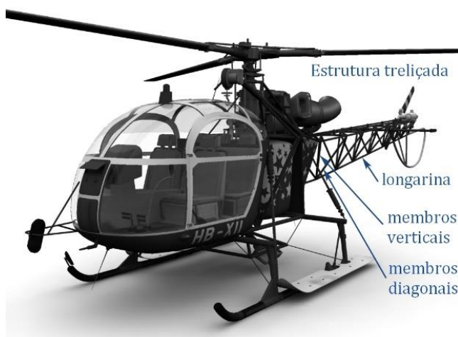
Figura 2. Exemplos das formas construtivas das estruturas da fuselagem (treliçada, monocoque).
