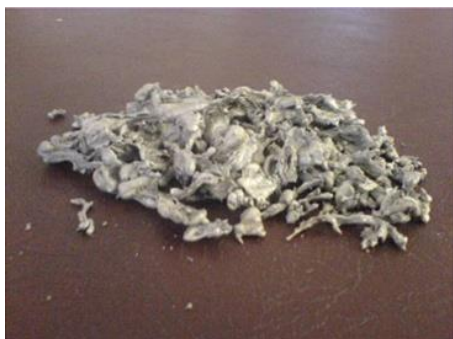
Рис. 1. Внешний вид гранул сплава гранул МА2-1гр.: а) отлитых в жидкий азот; б) отлитых в гелий
