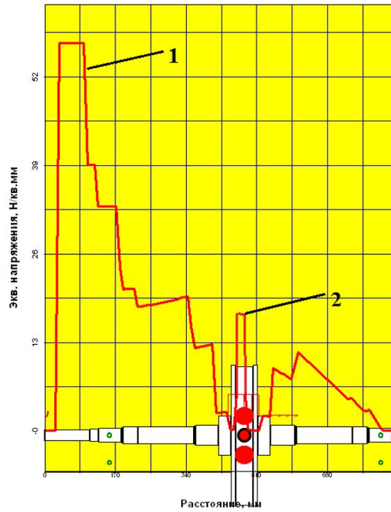
Рис. 4. График эквивалентных напряжений ротора насоса:
